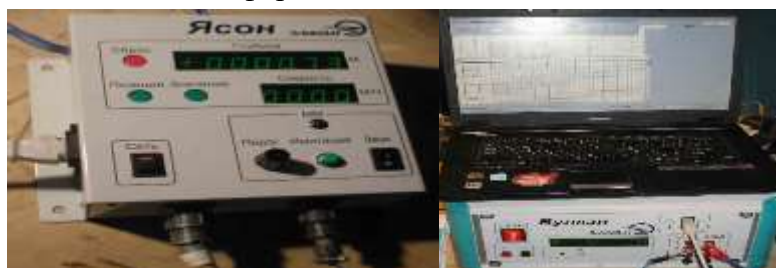
Рис. 3.2 Наземная регистрирующая аппаратура для ПРК-4203
