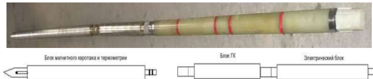
Рис. 3.1 Каротажный скважинный снаряд ПРК-4203
